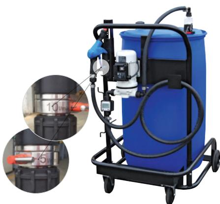
Carrello con pompa a 220 V, portata 30 L/min, 4 m di cavo, pistola automatica ZVA idonea al rifornimento delle autovetture (con regolazione 5-10 L/min tramite chiavetta di regolazione in dotazione) e 3 m di tubo in EPDM.
