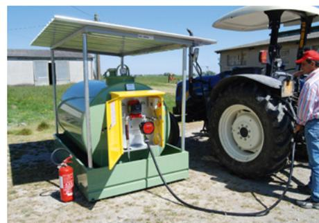
Tank Fuel con di bacino di contenimento con volume pari al 50% della capacità geometrica del serbatoio.
