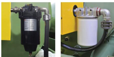
A. ES-Filter: 70 l/min; capacità filtrante: 10µm assorbimento acqua e 5µm impurità.
