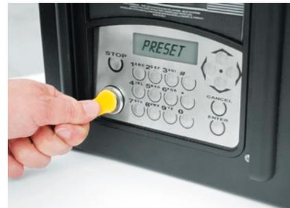
MC BOX è un pannello di controllo multi-utente. Con questo dispositivo elettronico è possibile controllare e monitorare il consumo di carburante ad uso privato.
