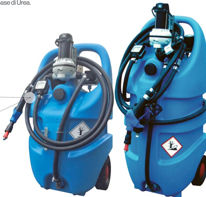
Contenitori in polietilene con pompa a batteria 12 o 24 V, portata 30 L/min, 4 m di cavo con connettori da batteria, pistola automatica ZVA idonea al rifornimento delle autovetture (con regolazione 5-10 L/min tramite chiavetta di regolazione in dotazione) e 3 m di tubo in EPDM.
