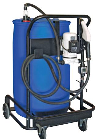
Carrello per il rifornimento di AdBlue® a mezzi operativi e di cantiere, macchine agricole e autocarri in genere, dotato di pompa a 220 V con portata 30 L/min, 4 m di cavo, pistola automatica e 3 m di tubo in EPDM. Emiltrolley® può in alternativa essere equipaggiato di pistola manuale così come di pompa manuale.
