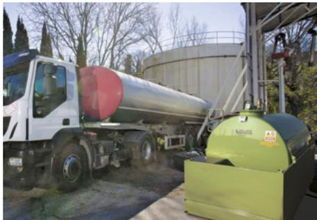
I serbatoi sono del tipo ad asse orizzontale, cilindrici, costruiti con fondi bombati e lamiera calandrata in acciaio al carbonio S 235 JR UNI - EN 10025, saldati mediante processo di saldatura ad arco sotto protezione di gas e successivamente trattati con uno strato di antiruggine ed uno strato di smalto a finire di colore verde. Sono collaudati a tenuta mediante prova pneumatica.
